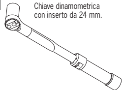
Chiave Campagnolo® UT-BB080 per montaggio movimento centrale RECORD/CHORUS.
