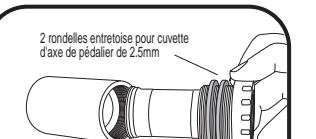
a) Appliquer une couche de graisse sur les filetages à l'intérieur du boîtier de pédalier du cadre.
