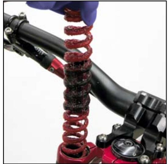
**5** 新しいコイル・スプリングの狭く巻き終わられている終端を確かめます。グリス用ブラシを使用して、新しいコイル・スプリング全体にグリスをたっぷりと塗ります。狭く巻き終わられている終端を先にして、アッパーチューブ内に新しいコイル・スプリングを取り付けます。
