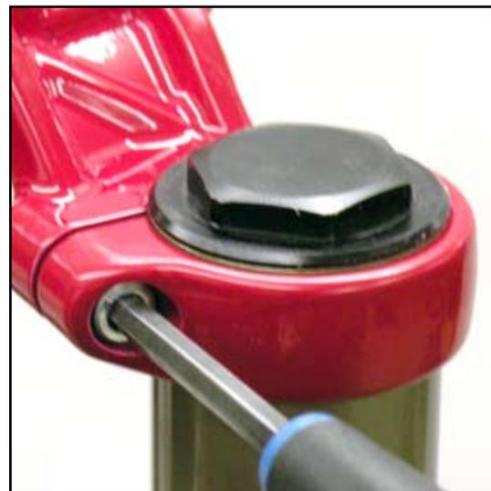
**10** Une fois le ressort hélicoïdal remplacé, mesurez de nouveau l'affaissement en suivant les instructions ci-dessus. Vérifiez que l'affaissement se trouve bien maintenant dans la plage indiquée.
