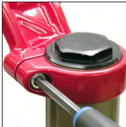
**2** Utilizzare una chiave a bussola da 24 mm per allentare e rimuovere il tappo superiore dello stelo sinistro. Durante la rimozione del tappo superiore prestare attenzione a non danneggiare l'o-ring. Se durante la rimozione l'o-ring del tappo superiore viene danneggiato, è necessario sostituirlo con un o-ring nuovo.
