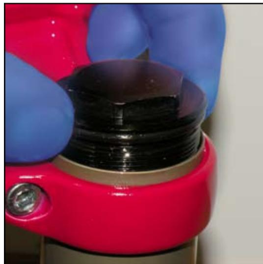
**8** Ziehen Sie die Abdeckkappe mit einem 24-mm-Steckschlüssel mit 7,3 N·m fest.
