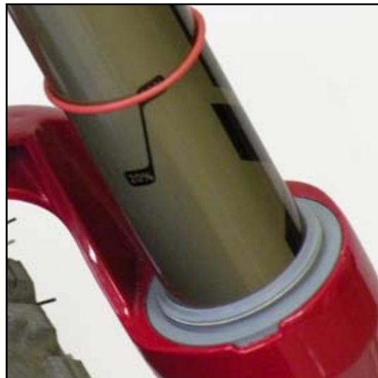
Se non si riesce a tarare la forcella in modo tale che l'abbassamento rientri nell'intervallo indicato, potrebbe essere necessario sostituire la molla elicoidale (Taratura della molla elicoidale). Per ottenere il corretto abbassamento attenersi alle informazioni specifiche per la taratura riportate di seguito.
