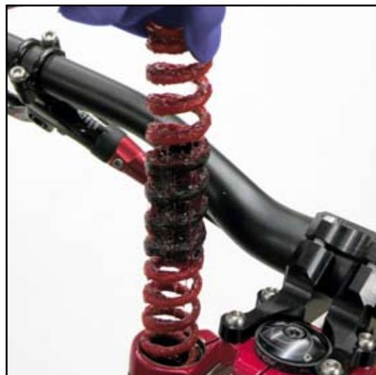
**5** Fassen Sie die neue Schraubenfeder am Ende mit der engen Windung. Tragen Sie mit einer Fettbürste reichlich Schmierfett auf der gesamten Länge der neuen Schraubenfeder auf. Bauen Sie die Schraubenfeder mit dem Ende mit der engen Windung zuerst in das obere Gabelrohr ein.
