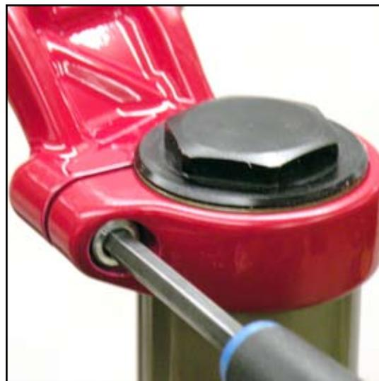
**2** Maak de bovendop, aan de niet-aandrijfzijde van de vorkbeen, los met behulp van een 24 mm dopsleutel. Let op dat u tijdens het verwijderen de bovendop o-ring niet beschadigt. Als de bovendop o-ring wordt beschadigd tijdens het verwijderen, vervang deze door een nieuwe.
