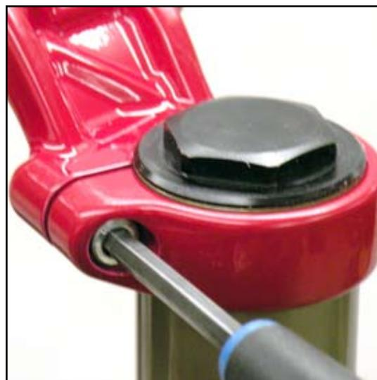
**2** 24 mm のソケットレンチを使用して、非ドライブ側のフォーク・レッグ上にあるトップキャップを緩めて、取り外します。取り外す際に、トップキャップ o-リングに損傷を与えないように注意してください。取り外し中にトップキャップ o-リングが損傷した場合は、新しい o-リングと交換する必要があります。
