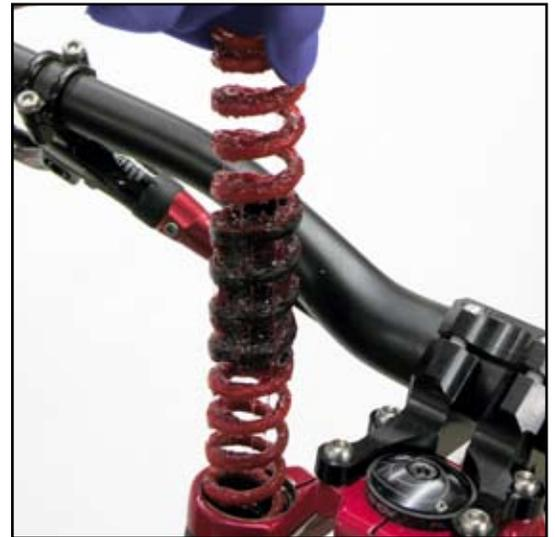
**5** 找到新卷簧紧卷的发条端。使用润滑脂刷在整个新卷簧涂上足量的润滑脂。将卷簧安装进上管（紧卷的发条端先进入）。
