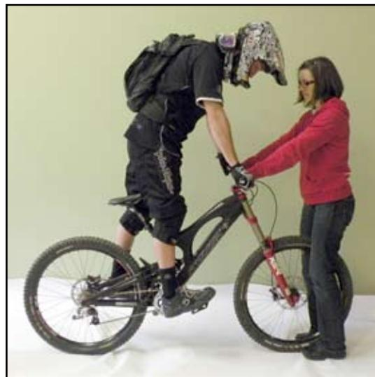
**4** Blijf stilstaan op de pedalen en laat uw vriend(in) de indicator o-ring naar beneden schuiven tot tegen de afstrijker. Zeg tegen uw vriend(in) om snel te zijn aangezien dit niet zo gemakkelijk is!
