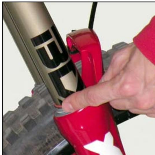
**5** Scendere con cautela dalla bicicletta e confrontare la posizione dell'o-ring indicatore della corsa con l'indicatore del valore di abbassamento riportato sul tubo superiore. Il valore ottenuto corrisponde all'abbassamento.
