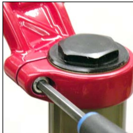
**2** Avec une clé à douille de 24 mm, desserrez et déposez le cabochon supérieur situé sur le tube de fourche du côté opposé à la chaîne. Veillez à ne pas endommager le joint torique du cabochon supérieur lors de la dépose. Si le joint torique du cabochon est endommagé lors de la dépose, remplacez-le par un joint neuf.
