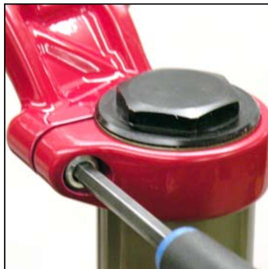
**2** Use uma chave de caixa de 24 mm para afrouxar e retirar a tampa superior localizada na perna do garfo, do lado sem cremalheiras. Tenha cuidado para não danificar o anel vedante O-ring da tampa superior ao retirá-lo. Se o anel vedante O-ring da tampa superior for danificado ao ser retirado, terá de o substituir por um novo anel O-ring.
