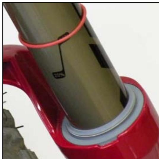
Si no consigue ajustar el hundimiento de la horquilla dentro del rango indicado, puede que necesite cambiar el muelle helicoidal (ajuste del muelle helicoidal). Para obtener el hundimiento adecuado, utilice los datos concretos de ajuste que se muestran a continuación.
