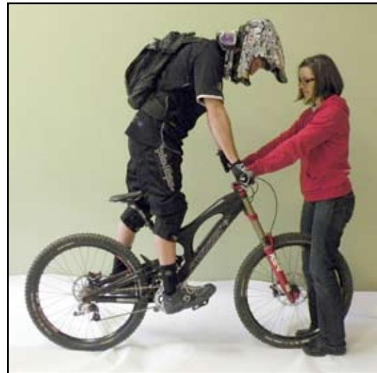
**4** ペダル上に立ち続け、友達にインディケータ o-リングの位置をワイパー・シールの方向へスライドしてもらいます。タイミングが大切ですので、素早く動かしてください！
