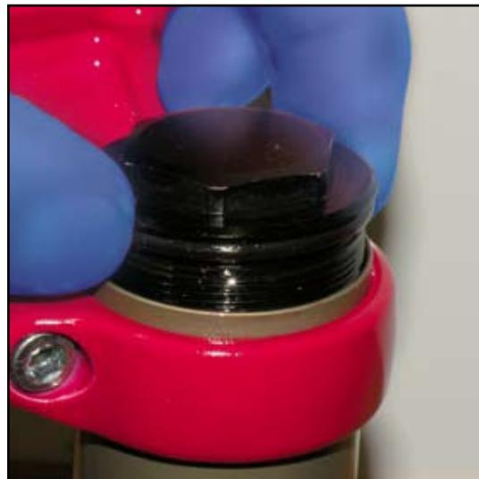
**8** Use uma chave de caixa de 24 mm e aperte a tampa superior a 7,3 N·m.
