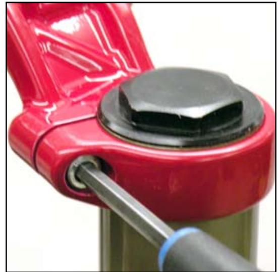
**2** 使用 24 mm 套筒扳手松开并卸下位于非传动侧前叉管上的上顶冠螺栓。卸下时注意不要损坏顶盖 O 形密封圈。如果顶盖 O 形密封圈在拆卸时损坏，您必须用新的 O 形密封圈更换。
