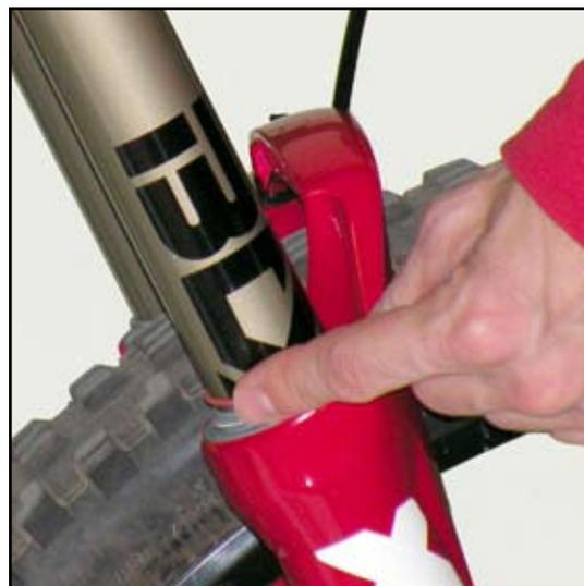
**5** Steigen Sie vorsichtig vom Fahrrad ab und prüfen Sie die Position des O-Rings für die Federweganzeige relativ zur Nachgiebigkeitsskala am oberen Gabelrohr. Dieses Maß ist die Nachgiebigkeit der Gabel.
