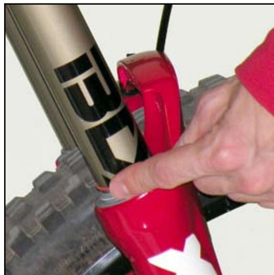
**5** Bájese con cuidado de la bicicleta y compare la posición de la junta tórica del indicador de recorrido con los gradientes de valor de hundimiento que aparecen marcados sobre el tubo superior. El resultado obtenido es el hundimiento.
