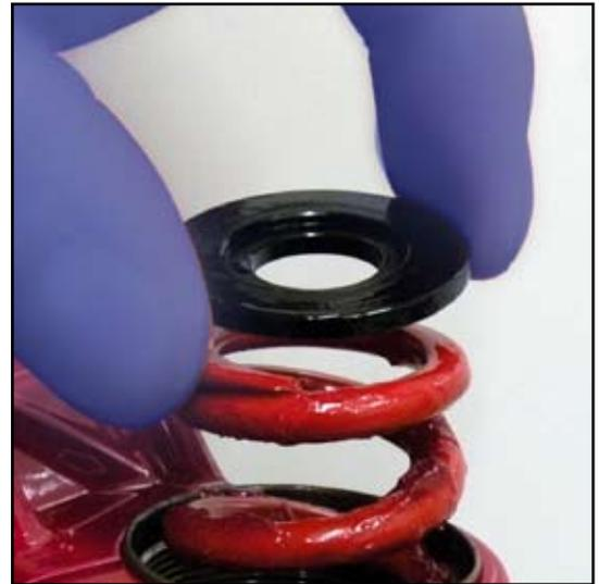
**4** フォークをもう一度わずかに圧縮させてコイル・スプリングにアクセスし、コイル・スプリングを手で取り外します。
