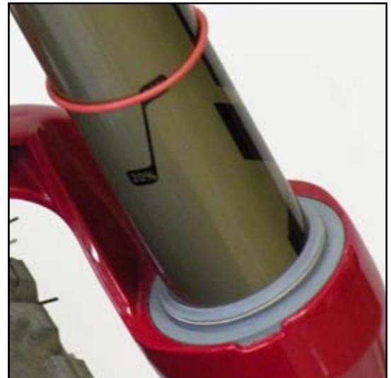
Se não for capaz de afinar o seu garfo para que tenha uma retracção dentro dos limites indicados, poderá ter que substituir a mola helicoidal (afinação da mola helicoidal). Use as informações específicas para a afinação que se seguem para conseguir uma retracção apropriada.
