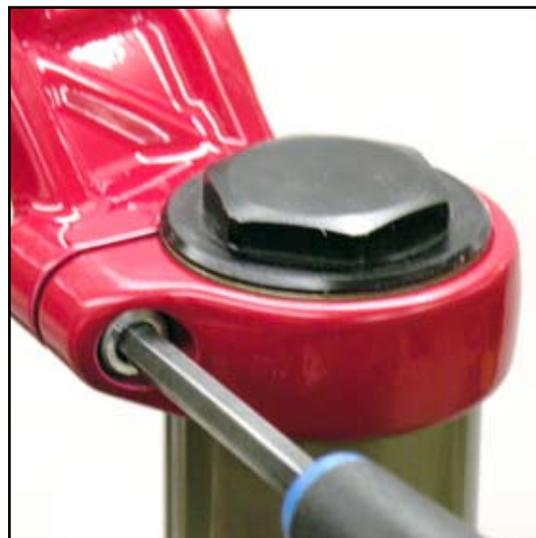
**10** Dopo aver sostituito la molla elicoidale, misurare di nuovo l'abbassamento seguendo le istruzioni fornite in precedenza, per assicurarsi che il valore dell'abbassamento rientri nell'intervallo indicato.
