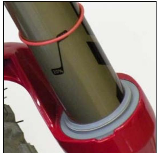
S'il n'est pas possible de régler l'affaissement dans la plage indiquée, il vous faut peut-être remplacer le ressort hélicoïdal (réglage du ressort hélicoïdal). Reportez-vous aux informations spécifiques notées ci-dessous pour optimiser le réglage de l'affaissement.
