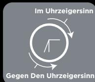
„Im Uhrzeigersinn“ und „gegen den Uhrzeigersinn“ gilt für die Drehrichtung eines Knopfes, Einstellers oder Hebels, wobei davon ausgegangen wird, dass Sie gerade auf das jeweilige Element blicken. Dies gilt für alle FOX-Gabeln und -Dämpfer.
