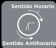
Los términos “horario” y “antihorario” se refieren a la dirección de giro del mando o la maneta, según se ve el mando de frente. Todo esto se aplica por igual a todos los productos de suspensión trasera y horquillas FOX.
