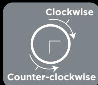
"右回り (clockwise)" および "左回り (counter-clockwise)" は、ノブまたはレバーによるコントロールの回転方向を示し、コントロールに対して正面から向かった位置を基準にしています。これは、すべての FOX フォークとリアショック製品に適用されます。
