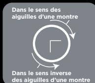
Quand on parle de « dans le sens des aiguilles d'une montre » et de « dans le sens inverse des aiguilles d'une montre », on fait référence au sens de rotation des molettes ou leviers, relatif à la commande en question quand on la regarde de face. Cette convention s'applique à tous les composants FOX (fourches et suspensions arrières).
